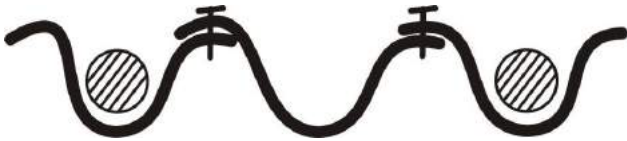
Рисунок 3. Способ установки крестовин на крышу из шифера или рифленого материала
