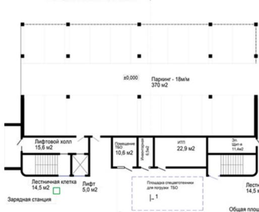
Планировочная схема типового этажа
